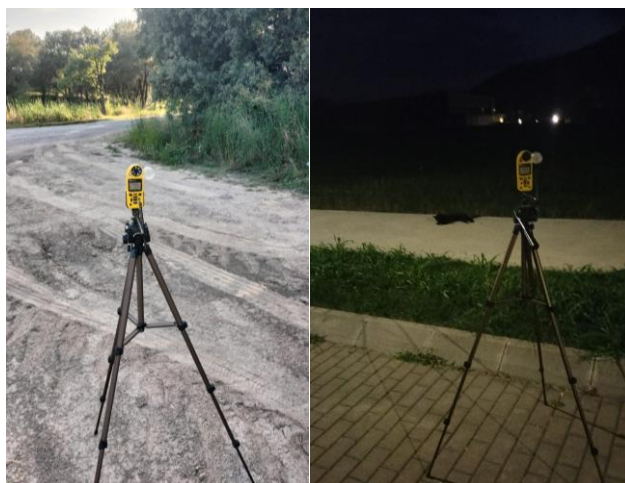
Figura 2. Detall de l'estació meteorològica Kestrel 5500
